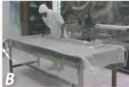
B Komponen utama ditutup plastik sebagai bak airnya dan kasa nyamuk sebagai alat untuk mengangkat kain yang akan dikeringkan.
