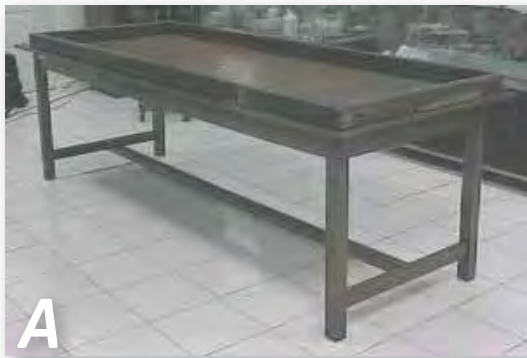
A Panel kayu berbentuk segi empat diatas meja sebagai komponen pokok meja cuci. Ukuran kayu 93 x 160 cm. Tebal: 2 cm dan Tinggi: 5 cm.
